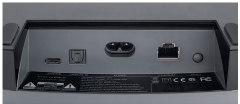
Die Soundbar verzichtet auf HDMI. Für den Anschluss eines Fernsehers steht lediglich ein optischer Toslink-Digital-Eingang bereit. Wer statt WLAN zur Vernetzung lieber Kabel verwenden mag, findet einen Ethernet-Anschluss auf der Rückseite des Geräts.
