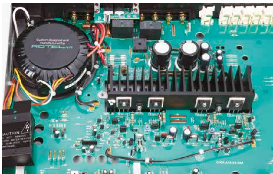
▲ Ein sehr ordentlicher Ringkerntrafo zeichnet das klassisch aufgebaute Netzteil aus.
